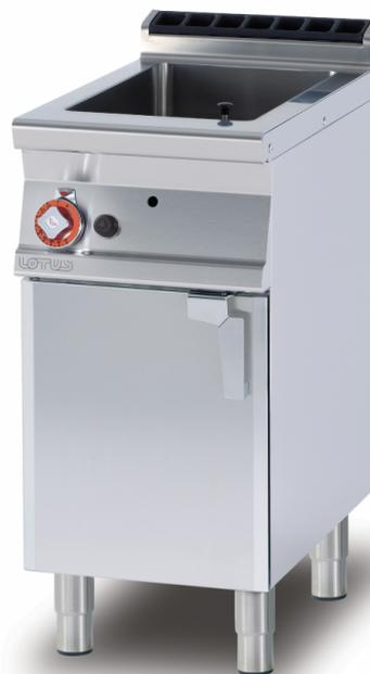
**Costruzione** - Modello realizzato interamente in acciaio inox CrNi 18/10 AISI 304, con piano di spessore 2 mm, satinatura superficiale Scotch-AF436Brite, particolari cromati, profili arrotondati. Piani dotati di alzatina posteriore. Manopole con grado di protezione all'acqua IPX5.
