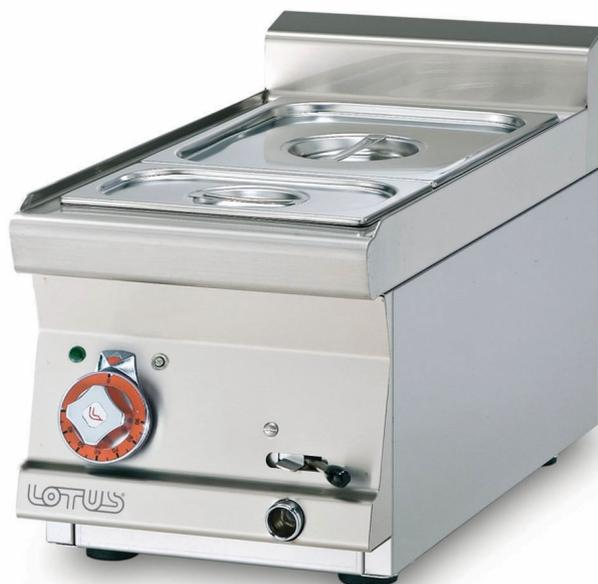
**Costruzione** - Modello realizzato in acciaio inox CrNi 18/10 AISI 304, con piano di spessore 1 mm, satinatura superficiale Scotch-Brite, particolari cromati, profili arrotondati. Piani dotati di alzatina posteriore. Manopole con grado di protezione all'acqua IPX5. Modello - Bagnomaria elettrico, per uso professionale. Vasche stampate per contenimento bacinelle Gastronorm di profondità 150 mm. Controllo termostatico.
