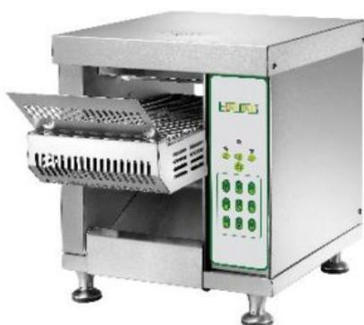
Tostapane per tostare pane a ciclo continuo. Struttura in acciaio inox - tappeto di tostatura girevole in acciaio inox - camera di cottura con isolamento termico - regolatore velocità di scorrimento tappeto di cottura elettronico - 3 modalità accensione resistenze - uscita del pane tostato frontale o posteriore. Tempo di cottura dai 90 ai 340 secondi.
